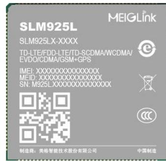
SLM925L 系列模组, 采用高通骁龙 600 系列 QCM6125, 该 CPU 采用 11nm FinFET 制程, 内置 64bit ARM、8 核 Kryo (4\*A73 2.0GHz & 4\*A53 1.8GHz), 支持 Decode/encode 最高 4K@30fps, H.265, 搭载 Android 10 操作系统, 支持板卡内存为 64GB+4GB (32GB+4GB, 64GB+6GB 等), 支持 LTE Cat6 和 2\*20MHz 的载波聚合, 最大下行速率可达300Mbps, 支持 TD-LTE/FDD-LTE/WCDMA/EVDO/TD-SCDMA/CDMA/GSM 多种网络制式, 集成了 GNSS 和 2.4&5G WIFI的宽带智能无线通信模块。
